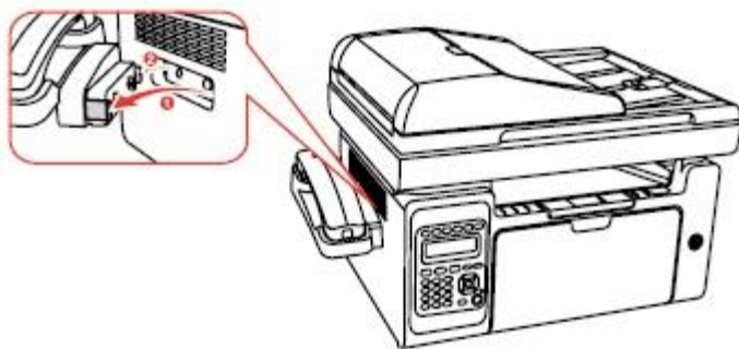
M6600 系列话机底座卸载示意图
